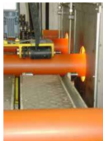
Qui sopra: alcune immagini di tubi TriPlo+ in cantiere e durante la fase di termoformatura del bicchiere. Nella foto di sinistra si può vedere come le condizioni climatiche estreme non siano un ostacolo per l'installazione di TriPlo+
