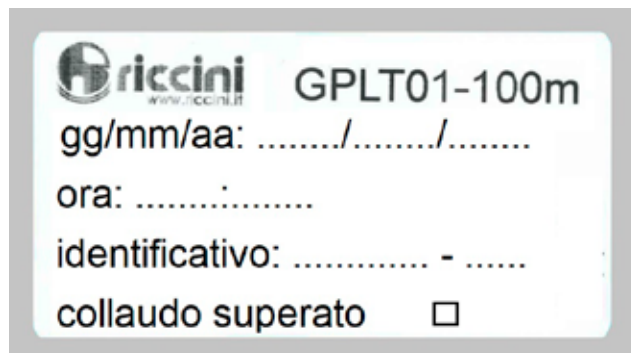
Qui sopra: esempio di etichetta identificativa e di collaudo che accompagna il pallet delle sonde
